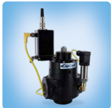
Kombinationsbeispiel: Booster mit Proportionalventil und 2. Rückführung über Druckmessumformer
